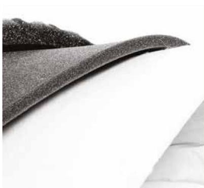
Schiuma poliuretana a base di poliesteri, flessibile, a cellule aperte, utilizzata per l'assorbimento acustico.
