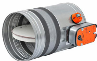
Serrande tagliafuoco marchiate CE certificate UNI EN 15650, classificate secondo UNI EN 13501-3 e testate secondo UNI EN 1366/2. Installabili su condotte di aerazione garantiscono una rapida interruzione del flusso d'aria in caso di incendio. Attuato con servomotore.
