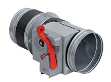
Serrande tagliafuoco marchiate CE certificate UNI EN 15650, classificate secondo UNI EN 13501-3 e testate secondo UNI EN 1366/2. Installabili su condotte di aerazione garantiscono una rapida interruzione del flusso d'aria in caso di incendio. Possono essere attuate con servomotore, elettromagnete o fusibile termico a riarmo meccanico.
