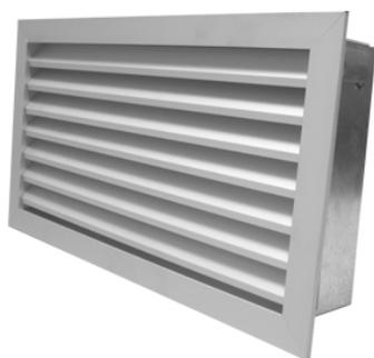
Griglie di ripresa portafiltro ad alette fisse inclinate di 45° passo 25 mm, con controtelaio removibile per l'alloggiamento e la sostituzione del filtro
