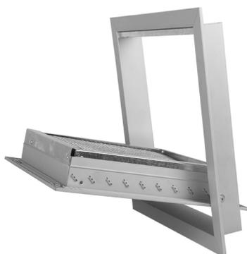
Griglie di aspirazione portafiltro ad alette fisse inclinate di 45° passo 25 mm, con controcornice imperniata lateralmente per l'alloggiamento e la sostituzione del filtro
