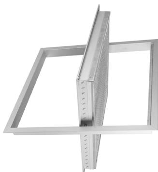
Griglie di aspirazione portafiltro ad alette fisse inclinate di 45° passo 25 mm, con controcornice imperniata centralmente per l'alloggiamento e la sostituzione del filtro
