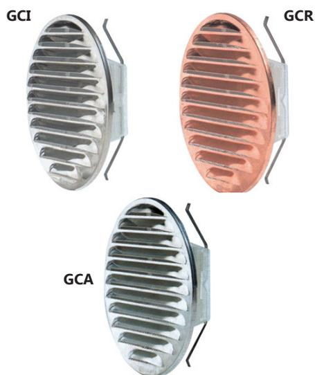
Griglie circolari universali in acciaio inox (GCI), rame (GCR) e alluminio (GCA) con molle. Con sole 4 misure coprono un'estensione applicativa variabile da un Ø min. di 80 mm ad un Ø max di 200 mm. Ha la possibilità di piegare la molla a 90° con una considerevole riduzione dello spazio necessario per l'immagazzinamento
