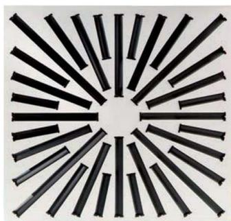
Diffusore a effetto elicoidale con deflettori mobili regolabili disposti su una elicoide con un elevato rapporto di induzione (capacità di miscelazione) tra aria immessa e aria ambiente
