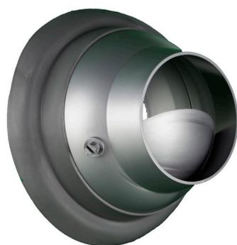
Diffusore con sistema brevettato (nr. MI2004A002299), per aggancio rapido sia su condotte a sezione rettangolare che a sezione circolare, orientabile manualmente in ogni direzione. Il flusso dell'aria in uscita può essere regolato per mezzo di un pomello presente sul corpo dell'ugello collegato a una serranda interna
