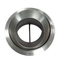
Diffusore orientabile in ogni direzione con un'inclinazione massima di ±30°, la regolazione è automatica, senza l'ausilio di alimentazione elettrica, mediante un attuatore termostatico costituito da speciali materiali a memoria di forma in NichelTitanio
