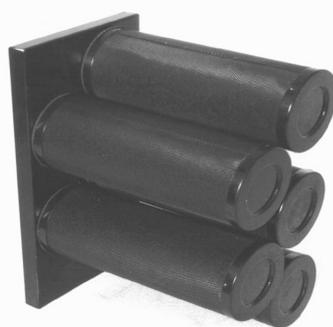
I filtri multipli Carbofil MC sono costituiti da cartucce cilindriche toroidali di lamiera microstirata chiusi da appositi fondelli in lamiera zincata. L'intercapedine è riempita con carbone attivo ed il filtro può essere collegato con innesto a baionetta su una opportuna piastra di supporto.
