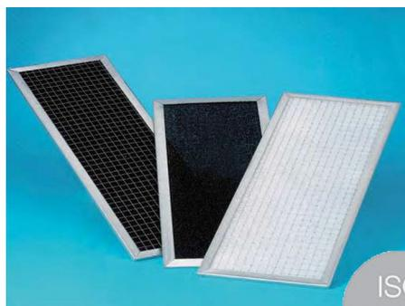
Cella filtrante piana sintetica per ventilconvettori, con telaio di supporto sezione ad U in acciaio zincato e doppia rete in filo zincato elettrosaldato per contenimento **tessuto filtrante** in fibra di poliestere serie AT100 in fiocco termolegante con grammatura di 100 gr/m<sup>2</sup> spessore di 5-10 mm.
