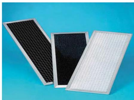
Cella filtrante piana sintetica per ventilconvettori con telaio sezione ad U in acciaio zincato, doppia rete in filo zincato elettrosaldato che supporta il **tessuto filtrante** in fibra sintetica di poliestere in fiocco termolegante impregnata con carboni attivi serie AC CARBON con grammatura di 200 gr/m<sup>2</sup> e spessore di 5-10 mm
