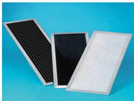
Cella filtrante piana sintetica per ventilconvettori con telaio sezione ad U in acciaio zincato, doppia rete in filo zincato elettrosaldato che supporta il **tessuto filtrante** in fibra sintetica in schiuma di poliuretano rigido serie PR20/06 di spessore di 6 mm, reticolata con cellule aperte a distribuzione uniforme. Questo tipo di media filtrante è facilmente rigenerabile mediante soffio di aria o lavaggio.
