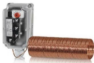
L'apparecchio è costituito da una custodia in ABS (base) e PC trasparente (coperchio) in esecuzione autoestinguenta classe V0. Le parti interne sono in tecnopolimero e acciaio inox per garantirne la stabilità meccanica. L'elemento sensibile è in rame riempito a gas.
