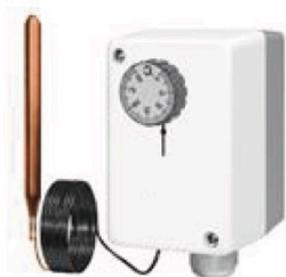
I termostati elettromeccanici TC sono composti da un tubo capillare riempito con fluido, rivestito in PVC, e da una custodia contenente il sensore che trasmette i cambiamenti di temperatura ad un micro-switch con contatti in commutazione con una portata massima di NC 16(4)A 250 V AC - NO 10(6)A V AC
