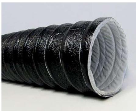
Condotto flessibile coibentante realizzata con film di resine poliolefiniche additivate, rivestimento termoisolante in polietilene reticolato ed espanso a cellule chiuse, protezione esterna film di resine poliolefiniche additivate, spirale incorporata in filo in acciaio armonico. L'assemblaggio dei materiali al fine della costruzione del condotto flessibile non prevede l'utilizzo di agenti chimici, adesivi o collanti.
