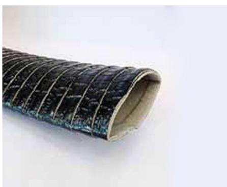
Guaina flessibile coibentante realizzata con film di resine poliolefiniche additivate, rivestimento termoisolante in polietilene reticolato ed espanso a cellule chiuse, protezione esterna film di resine poliolefiniche additivate. L'assemblaggio dei materiali al fine della costruzione del condotto flessibile non prevede l'utilizzo di agenti chimici, adesivi o collanti.
