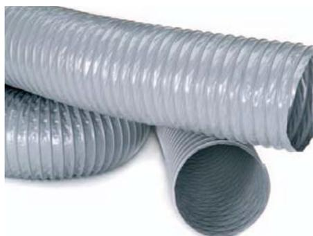
Tubo flessibile realizzato con tessuto in poliammide spalmato di PVC sui due lati e spirale incorporata in filo armonico. La speciale esecuzione consente l'impiego in tutte le installazioni di aspirazione e ventilazione dell'aria anche con parti in movimento.
