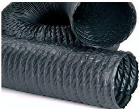
Tubo flessibile realizzato con tessuto in fibra di vetro spalmato di PVC sui due lati e spirale incorporata in filo armonico. La speciale esecuzione consente l'impiego in tutte le installazioni di aspirazione e ventilazione dell'aria anche con parti in movimento.
