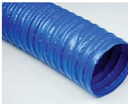
Tubo flessibile realizzato con uno speciale tessuto poliammidico, a doppia spalmatura di PVC con elevate caratteristiche di resistenza meccaniche e spirale incorporata in filo d'acciaio armonico.
