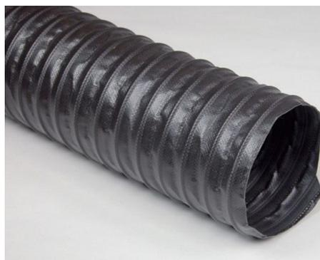
Tubo flessibile realizzato con uno speciale tessuto poliammidico, a doppia spalmatura di PVC antistatico, con elevate caratteristiche di resistenza meccaniche e spirale incorporata in filo d'acciaio armonico.
