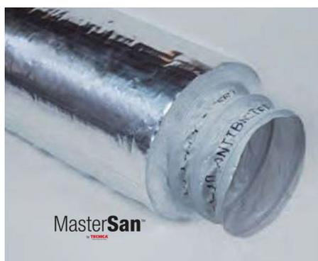
Condotto flessibile realizzato con film di resine poliolefiniche additate e master antibatterico/antimuffa, spirale in filo di acciaio armonico. Rivestimento termoisolante in fibra di poliestere (sp. 25 mm - 16 kg/m<sup>3</sup>). Protezione esterna in film alluminato (flame retardant).
