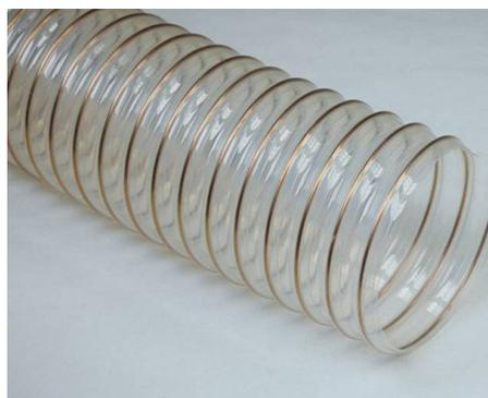
Tubo flessibile realizzato con foglia (sp. 0,40 mm) di poliuretano (Pu) e spirale in filo in acciaio armonico ramato/zincato. Caratteristica peculiare di questo tubo è la grande resistenza all'abrasione e al taglio (5/6 volte maggiore del caucciù e 7 volte più del PVC).
