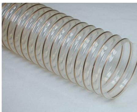
Tubo flessibile realizzato con foglia (sp. 0,45 mm) di poliuretano (Pu) e spirale in filo in acciaio armonico ramato.
