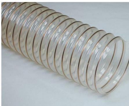
Tubo flessibile realizzato con foglia (sp. 0,45 mm) di poliuretano-etero (Pu) compatibile alimentare e spirale in filo di acciaio armonico ramato. Caratteristica peculiare di questo tubo è la grande resistenza all'abrasione e al taglio (5/6 volte maggiore del caucciù e 7 volte più del PVC).
