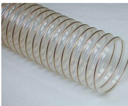
Tubo flessibile realizzato con foglia (sp. 0,45 mm) di poliuretano-estere (Pu) antistatico  $R \leq 10^8 \Omega$  e spirale in filo d'acciaio armonico ramato. Caratteristica peculiare di questo tubo è la grande resistenza all'abrasione e al taglio (5/6 volte maggiore del caucciù e 7 volte più del PVC).
