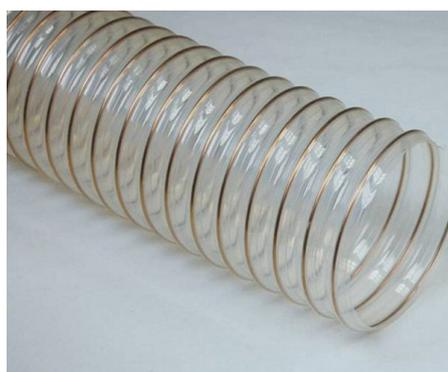
Tubo flessibile realizzato con foglia (sp. 0,60 mm) di poliuretano-estere (Pu) Antistatico  $R \leq 10^8$  Ohm e spirale in filo di acciaio armonico ramato. Caratteristica peculiare di questo tubo è la grande resistenza all'abrasione e al taglio (5/6 volte maggiore del caucciù e 7 volte più del PVC).
