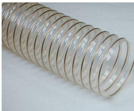
Tubo flessibile realizzato con foglia (sp. 0,60 mm) di poliuretano-etero (Pu) compatibile alimentare e spirale in filo in acciaio armonico ramato. Caratteristica peculiare di questo tubo è la grande resistenza all'abrasione e al taglio (5/6 volte maggiore del caucciù e 7 volte più del PVC).
