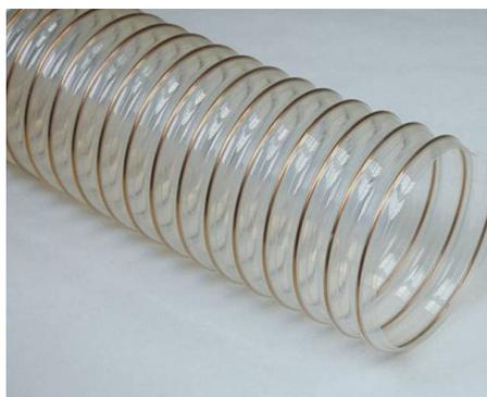
Tubo flessibile realizzato con foglia (sp. 0,70 mm) di poliuretano (Pu) e spirale in filo in acciaio armonico ramato. Superficie interna particolarmente scorrevole idoneo per impieghi gravosi (livello medio).
