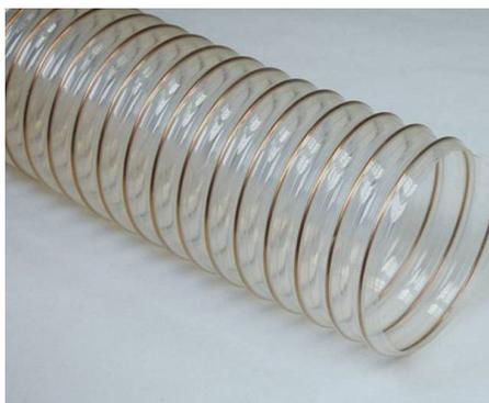
Tubo flessibile realizzato con foglia (sp. 0,70 mm) di poliuretano (Pu) e spirale in filo in acciaio armonico ramato.
