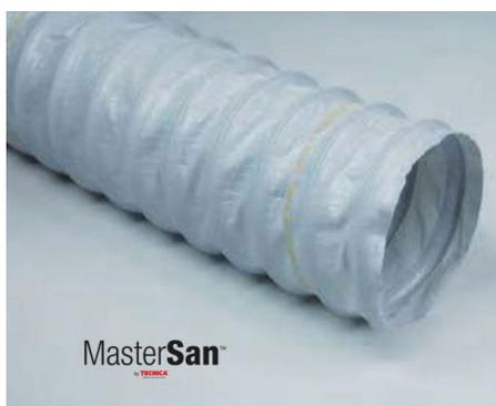
Condotto flessibile realizzato con tessuto poliestere spalmato di resine poliolefiniche additive e master antibatterico/anti-muffa, spirale in filo di acciaio armonico.
