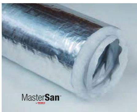
Condotto flessibile realizzato con tessuto poliestere spalmato di resine poliolefiniche additivate e master antibatterico/anti-muffa, spirale in filo di acciaio armonico. Rivestimento termoisolante in fibra di poliestere (sp. 25 mm - 16 kg/m<sup>3</sup>). Protezione esterna in film alluminato (flame retardant).
