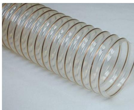
Tubo flessibile realizzato con foglia (sp. 1,10 mm) di poliuretano (Pu) e spirale in filo in acciaio armonico ramato. Superficie interna particolarmente scorrevole idonea per impieghi gravosi (alta abrasione).
