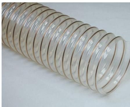
Tubo flessibile realizzato con foglia (sp. 1,10 mm) di poliuretano-etero (Pu) compatibile alimentare e spirale in filo in acciaio armonico ramato.
