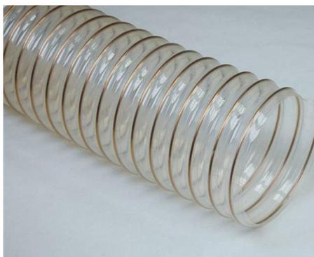
Tubo flessibile realizzato con foglia (sp. 1,10 mm) di poliuretano-estere (Pu) antistatico  $R \leq 10^8$  Ohm e spirale in filo in acciaio armonico ramato.
