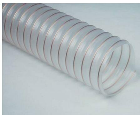
Tubo flessibile realizzato con foglia (sp. 0,45 mm) di termoplastico TPE e spirale in filo d'acciaio armonico ramato. La tubazione è particolarmente idonea per aspirazione di fumi aggressivi anche in presenza di diverse tipologie di acidi, basi e solventi.
