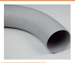
Tubo flessibile realizzato con robusto e speciale profilo di PVC, spiralato in elicoide. La rotazione delle spire in senso orario o antiorario consente una variazione in aumento o in diminuzione sino al 35% rispetto al diametro nominale.
