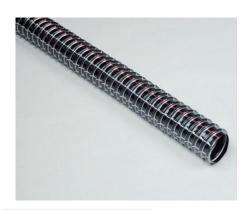
Tubo flessibile prodotto con due foglie di PVC (strato interno nero – strato esterno trasparente) e griglia di rinforzo tra i due strati. Spirale elicoidale interna in acciaio plastificato. Tubo molto leggero estremamente flessibile e con ottima resistenza alla depressione.
