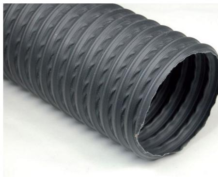
Tubo flessibile realizzato con tessuto poliammidico impregnato di santoprene e spirale incorporata in filo d'acciaio armonico. Particolarmente indicato quando si opera in presenza di fumi aggressivi.
