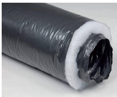
Condotto flessibile realizzato con film di resine poliolefiniche additivate e spirale in filo di acciaio armonico. Rivestimento termoisolante in fibra di poliestere (sp. 25 mm - 16 kg/m<sup>3</sup>). Protezione esterna antivapore in resina poliolefinica additivata.
