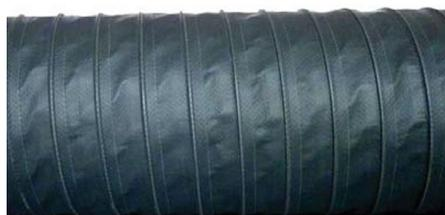
Tubo flessibile realizzato con tessuto in poliesterato spalmato di speciale PU per alte temperature e spirale incorporata in filo armonico. Grazie alla particolare esecuzione il tubo flessibile risulta essere leggero ma allo stesso tempo molto flessibile, resistente allo strappo e alle perforazioni.
