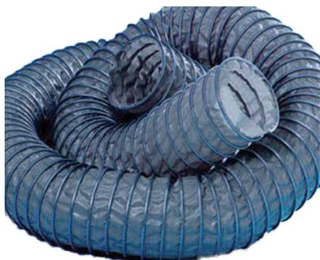
Tubazione estremamente leggera realizzata con tessuto in fibra di vetro spalmato di PTFE, spirale esterna con filo di acciaio zincato. Resiste sia alle alte che alle basse temperature, alle condizioni meteorologiche e agli aggressivi chimici. Il tubo risulta essere molto flessibile e comprimibile presentando un'alta forza di tensione. Il PTFE è molto sicuro per la salute di chi lo utilizza ed ha una superficie antiaderente.
