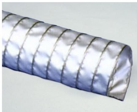
Tubo flessibile per alte temperature realizzato con tessuto in fibra di vetro spalmato di silicone e spirale esterna in acciaio zincato. Buona resistenza agli agenti chimici, ai raggi UV e all'ozono. Difficilmente infiammabile, molto flessibile e comprimibile con un'alta forza di tensione.
