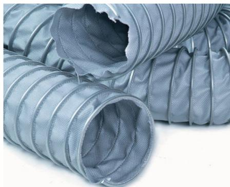
Tubo flessibile a doppio strato costituito da un tessuto per alte temperature spalmato di PU e rinforzato da una trama di acciaio inossidabile. La spirale esterna in acciaio zincato garantisce un'ottima protezione del tubo. Il flessibile è resistente alla fiamma, autoestinguente e non tossico in quanto non viene utilizzato silicone.
