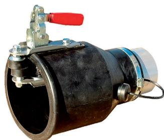
Le bocchette in gomma neoprende mob. GB sono idonee per il collegamento diretto con i tubi di scarico dei veicoli. Le bocchette coniche sono disponibili nei Ø 100, 140 e 1780 mm, e quelle cilindriche nei Ø 150 e 220 mm; possono essere integrate nei Ø 100 e 140 con tappo di diaframma (...T) e nei diametri 100, 140, 180 e 220 mm con pinza a scatto.
