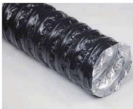
Condotto flessibile realizzato con parete di AL/PET/AL (alluminio/poliestere/alluminio) accoppiato con film poliolefिनico per garantire una maggiore resistenza meccanica all'alluminio. La spirale interna è realizzata in filo di acciaio armonico.
