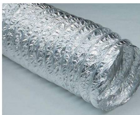
Condotto flessibile realizzato con parete di AL/PET/AL (alluminio/poliestere/alluminio) e spirale in filo di acciaio armonico.
