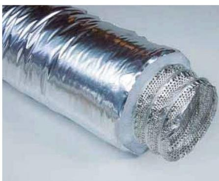
Condotto flessibile realizzato con parete in AL/PET/AL (alluminio/poliestere/alluminio) microforato per attenuazione del rumore passaggio aria e spirale elicoidale incorporata in filo di acciaio armonico, rivestimento termoisolante in fibra di poliestere (sp. 25 mm - 16 kg/m<sup>3</sup>), protezione esterna in film alluminato (flame retardant). La robustezza della fibra di poliestere termolegata evita la dispersione delle microfibre durante il passaggio dell'aria mantenendosi integra nel tempo.
