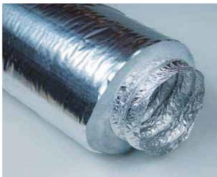
Condotto flessibile realizzato con doppia parete in AL/PET/AL (alluminio/poliestere/alluminio) e spirale in filo di acciaio armonico. Rivestimento termoisolante in fibra di poliestere (sp. 25 mm - 16 kg/m<sup>3</sup>), protezione esterna in film poliolefinico alluminato (flame retardant). La robustezza della fibra di poliestere termolegata evita la dispersione delle microfibre durante il passaggio dell'aria.
