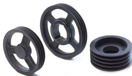
Pullegge PBT a gole trapezoidali per il montaggio con bussola conica, sono costruite in ghisa **DIN 1691 GG20 – GG25**. Sono adatte per funzionare sino a una velocità periferica di 35 m/s.
