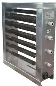
Realizzate con resistenze in acciaio inox corazzate alettate lineari o a "U". Telaio in acciaio zincato, vano di protezione e accesso ai collegamenti elettrici, grado di protezione IP40, termostato di sicurezza 30°/90°
