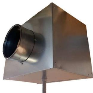
Costruite con telaio in lamiera zincata e una batteria di scambio termico con tubi in rame e alette in alluminio. Per gli attacchi aereaulici sono provviste di attacchi circolari maschio. Per gli attacchi idraulici sono dotate di attacchi filettati comprensive di valvole per lo scarico della batteria. Gli attacchi acqua sono sul lato sinistro con ingresso su quello più basso e uscita su quello più alto. Per ingresso aria si intende quello sul lato più distante dall'ingresso acqua.
