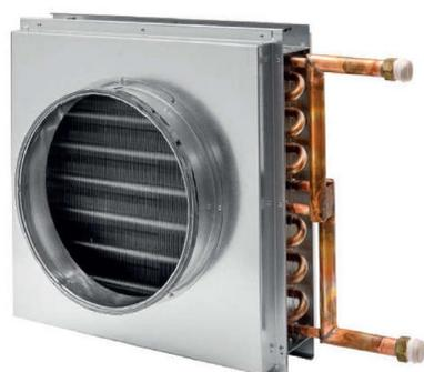
Costruite con due flange in lamiera zincata e una batteria di scambio termico con tubi in rame e alette in alluminio. Per gli attacchi aereaulici sono provviste di attacchi circolari maschio. Per gli attacchi idraulici sono dotate di attacchi filettati.
