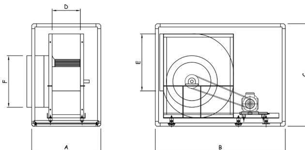
Ventilatore centrifugo cassonato a semplice aspirazione a trasmissione
